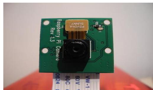
Fig:-Raspberry Pi Camera Module
